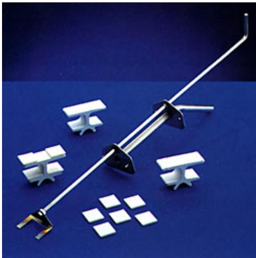
Устройство для загрузки и выгрузки образцов, держатель образцов и плиточки
